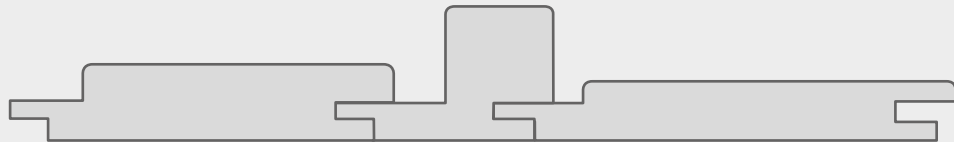
Profil 3D, combinaison des dimensions 3D P3 : 26 x 121 mm, 3D P1 : 40 x 69 mm, 3D P4 : 21 x 146 mm
